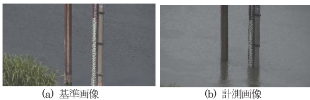
Fig. 2 画像式水位計 画像例
