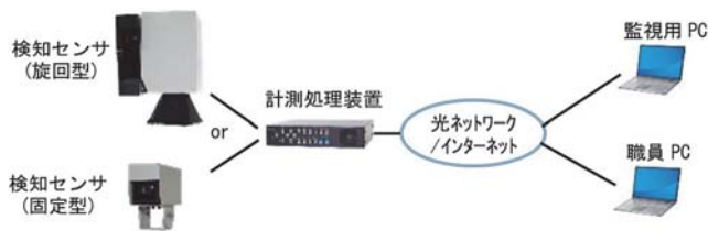
Fig. 5 画像式水位計 システム構成例
