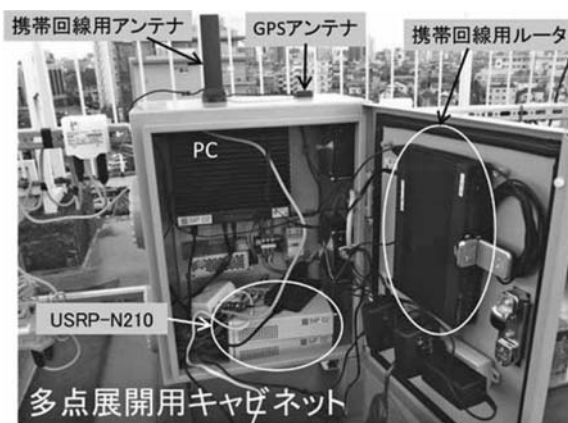
Fig. 2 ソフトウェア無線の技を用いて制作されたプロトタイプ観測装置
