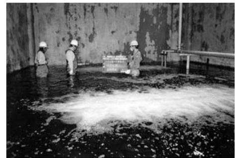
Photo. 1 超微細気泡散気装置発泡試験
