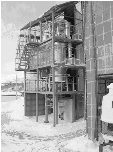
Fig.16 縦型連続式炭化装置の外観（大幸テック株式会社 山形小国工場）
