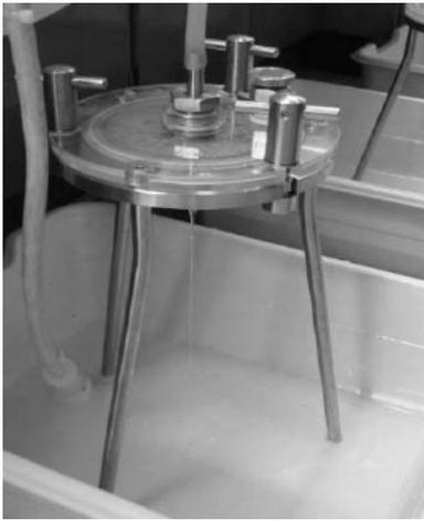
Fig.3 親水性 PTFE フィルター用の加圧式フィルターホルダー
